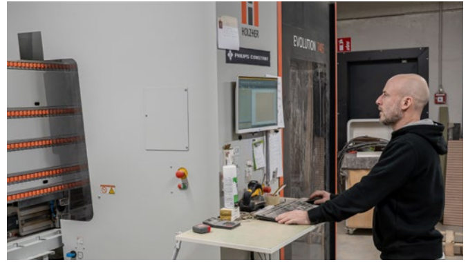
CNC-Daten werden direkt aus der Planung erzeugt und übertragen.
