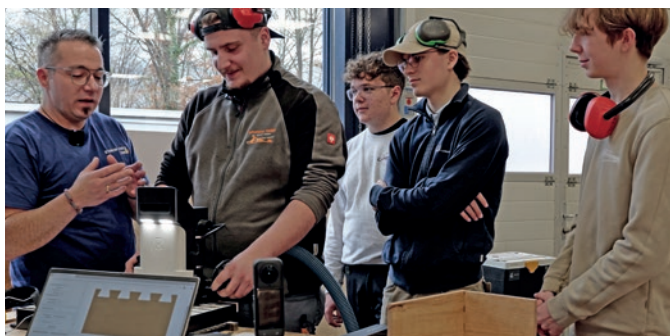
Die handgesteuerte CNC-Fräse Shaper Origin eignet sich ideal für erste CNC-Praxiserfahrungen im Unterricht. Durch die direkte Anbindung aus Palette CAD ist der Übergang von Planung zur Produktion praktisch erlebbar.
