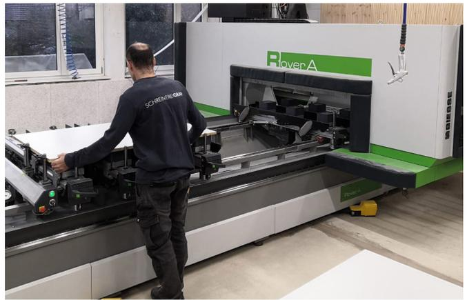
Die Konstruktionsdaten aus Palette CAD werden zur Fertigung an die CNC-Maschine BIESSE Rover 5 übermittelt.
